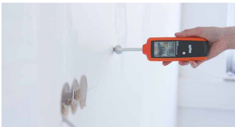
HFM 200 inkl. Feuchtemessgerät, 3 AA Batterien, Tasche / HTM 300 inkl. Hygro-Thermometer, 9 V-Batterie, Tasche
