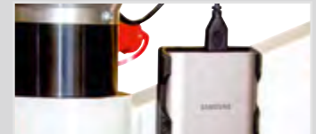
Laserpointer zur optischen Anzeige der Werkzeugmitte + Powerbank
