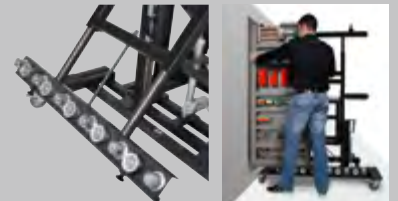
ROLLENBAHN zur seitlichen Einführung der Montageplatte in den Schaltschrank Art.-Nr. 031001-004
