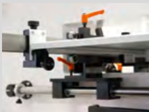
Wechselseitiges Schnelleinspannsystem für Abkantung wahlweise oben oder unten
