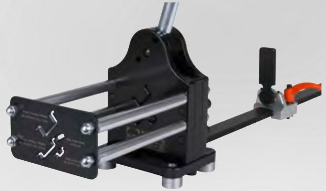
Führungsvorrichtung zum 90°- winkelgenauen Schneiden
