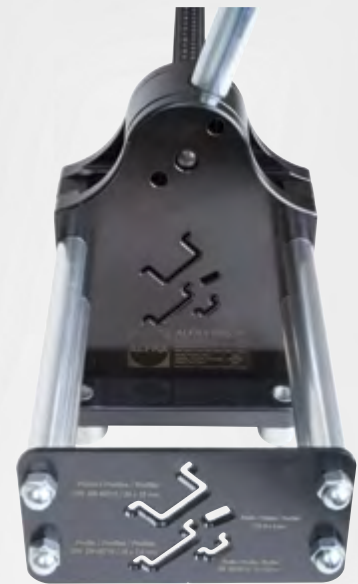
Führungsvorrichtung zum 90°- winkelgenauen Schneiden
