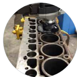
Vielseitiges Entgraten und Anfasen von Konturen, Radien und engen Bohrungen, 30°/45° Schweißnaht und Sichtkantenvorbereitung etc.
