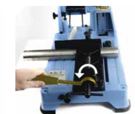
3. Nach dem Schnitt wird der Schnellspannhebel auf die linke Seite gelegt.
