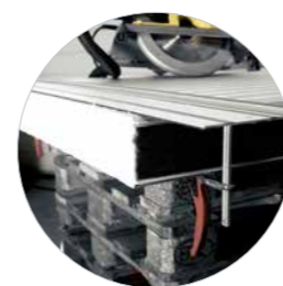
2x Klemmen für schnelles und einfaches Spannen
