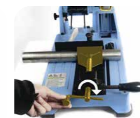
2. Das zu sägende Material wird mit der Spindel fixiert (einmaliger Vorgang).
