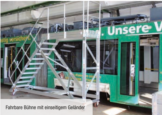
Höhenverstellbare Bühne mit ausklappbarem Geländer
