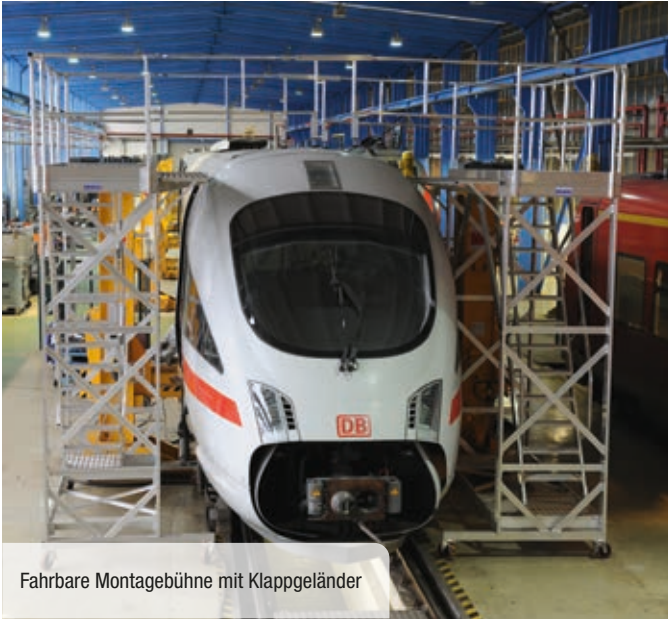
Laufboden mit Rammschutz und klappbarem Geländer
