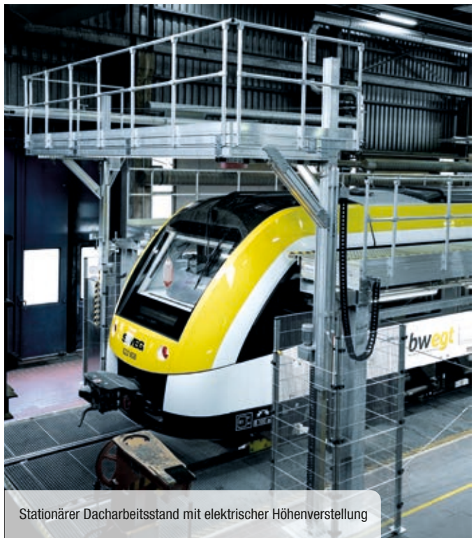
Laufboden mit Rammschutz und klappbarem Geländer
