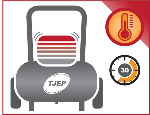
Der Kompressor ist für Intervallbetrieb von insgesamt höchstens **30 min** pro Stunde ausgelegt, um ausreichende Kühlung zu gewährleisten.
