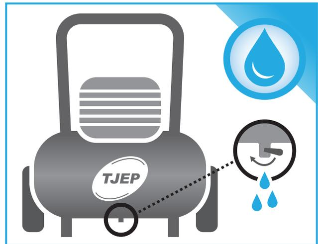
Denken Sie daran, den **Kondenswasserbehälter** des Kompressors täglich zu entleeren.
