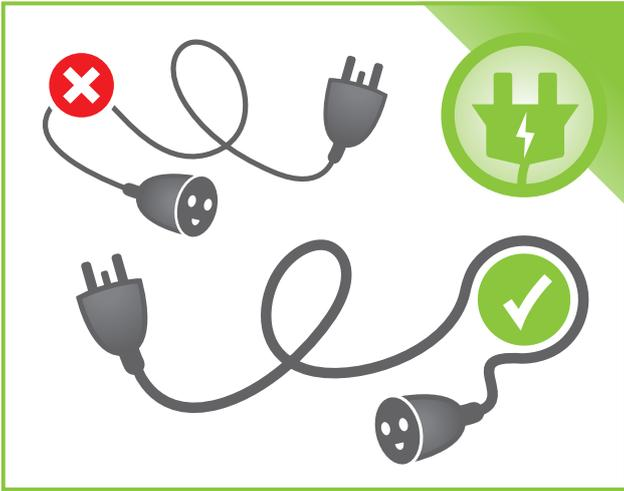
Verwenden Sie ein **hochbelastbares Verlängerungskabel** (min.  $3 \times 1,5 \text{ mm}^2$ ) mit einer separaten Sicherungsgruppe.
