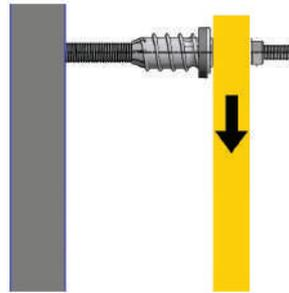
**Maximale Querlasten V <sup>1)</sup> eines Einzeldübels bei max. 3 bzw. 5 mm Verschiebung pro ResiTHERM® bei frei beweglichem <sup>2)</sup> äußeren Ende des ResiTHERM® 16 & 12 bei 24°C/40°C <sup>3)</sup>**
