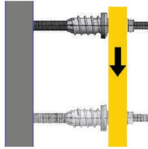
**Maximale Querlasten V <sup>1)</sup> eines EinzeldüBELs bei max. 3 bzw. 5 mm Verschiebung pro ResiTHERM<sup>®</sup> bei verdrehbehinderter Lagerung <sup>2)</sup> des freien äußeren Endes des ResiTHERM<sup>®</sup> 16 & 12 bei 24°C/40°C <sup>3)</sup>**
