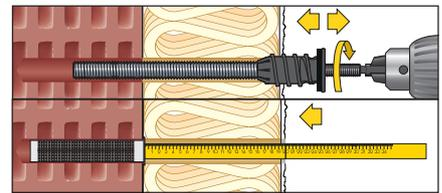
4. Die Öffnung im Putz für den Bund der Siebhülse auf 26 mm vergrößern. Dazu thermisches Trennmodul nur ca. 2 Gewingegänge durch den Putz kurzzeitig ein- und wieder herausdrehen oder Putz mit Bohrer aufreiben bzw. mit größerem 26 mm Bohrer aufbohren.
