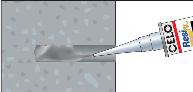
**Verbrauch in Vollbaustoffen** Berechnungsmethode: Füllung des Bohrlochs komplett\*)
