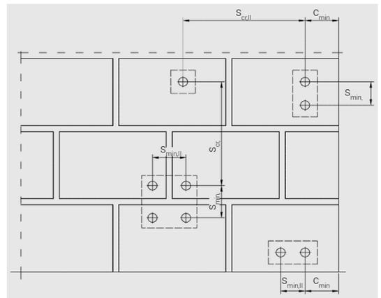
\* Werte gelten für  $s_{min,\perp}$ . Für  $s_{min,II}$  gilt 240 mm.
