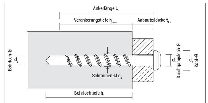
**BTS4 PT, galv. verz.** inkl. passendem SDS-Bohrer Ø 4 mm, Länge 110 mm
