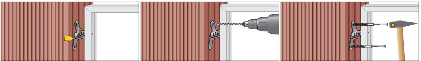
4. ProtectFIX von innen oder außen an der Fensterbauschraube FBS-Z einhängen. Die Schraube in eine der vier Aufnahmen positionieren und die Lasche waagrecht ausrichten.
