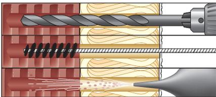
1. Bohrloch erstellen: Bohrdurchmesser = 20 mm. Bohrlochtiefe  $\geq 140 \text{ mm}$  + Dämmstoffdicke (inkl. Putz). Bohrverfahren der Zulassung/Bewertung des Injektionsmörtel ResiFIX beachten.
