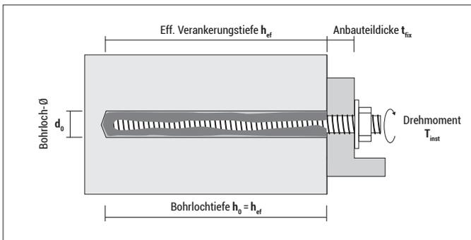
Injektionssystem ResiFIX PYSF
